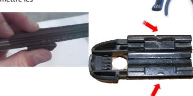
6. Remettre la pièce de fonte. Avec une pince, ou mieux, tout simplement avec les mains. La petite languette de la pièce de fonte doit entrer dans l'entaille de la tige métallique. Remettre le capuchon plastique de protection.
